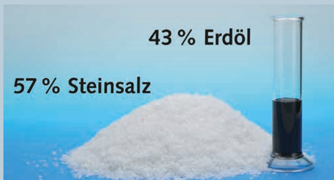
PVC besteht zu 43 % aus Erdöl und 57 % aus Salz, das aus heimischen Quellen gewonnen wird. | Abb.: Funke Kunststoffe
