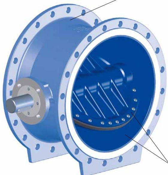
Der HYDROMAT® ist eine serienmäßig komplett emaillierte Armatur (Gehäuseaußenseite: schlagfestes Grundemail mit zähem 2K-Auftrag; Gehäuseinnenseite und Klappenscheibe: schlagfestes Vollemail).
